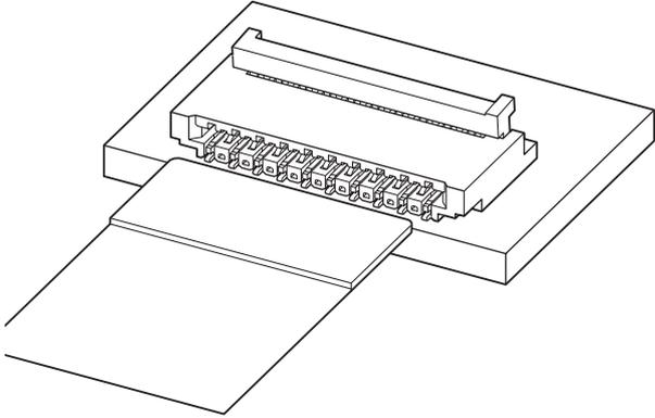
该产品是封装高度为 0.9mm 的薄型 ZIF 型 FPC 连接用连接器。
