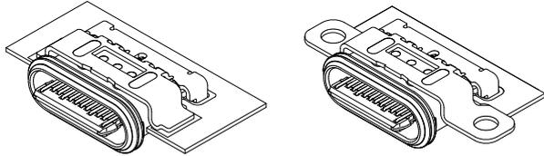
此UBC系列是符合IPX8（浸入2米水中达60分钟）的防水型接口连接器，根据JIS C 9020的防护评级，其防护等级为8。
